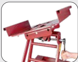
Bandeja inclinada 15° para a esquerda
